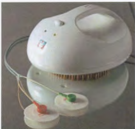
Рис. 1. Электроимпедансный компьютерный маммограф МЭИК®.
